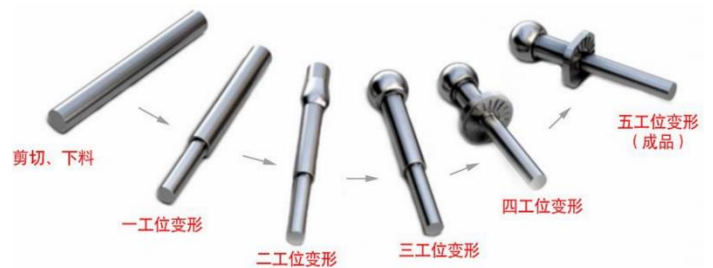
图表16: 五工位冷成形装备经过五次加工变形流程
