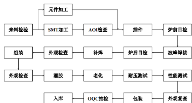
图 10：LED 驱动电源生产工艺
