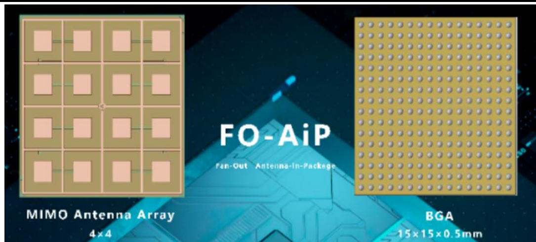
图表41:长电绍兴发布最新开发的 FO-AiP 东湖晶圆级异构集成技术
