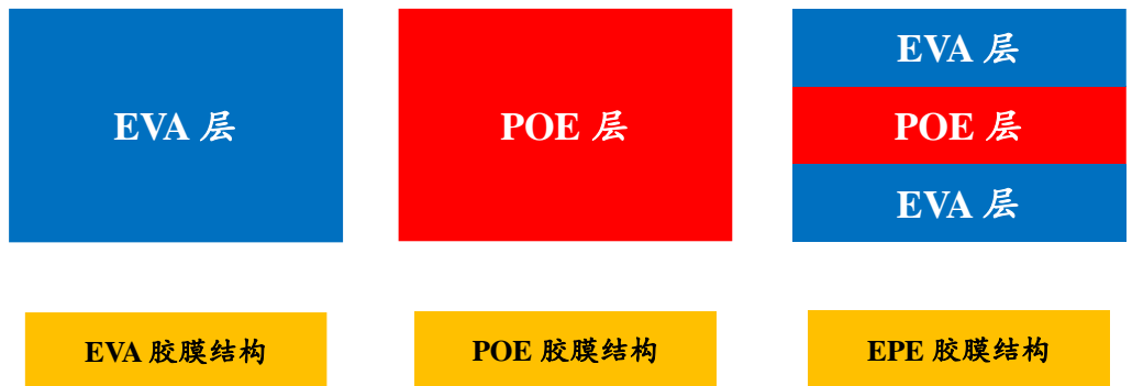
图30：光伏封装胶膜主要包括 EVA 胶膜、POE 胶膜、共挤型 POE 胶膜
