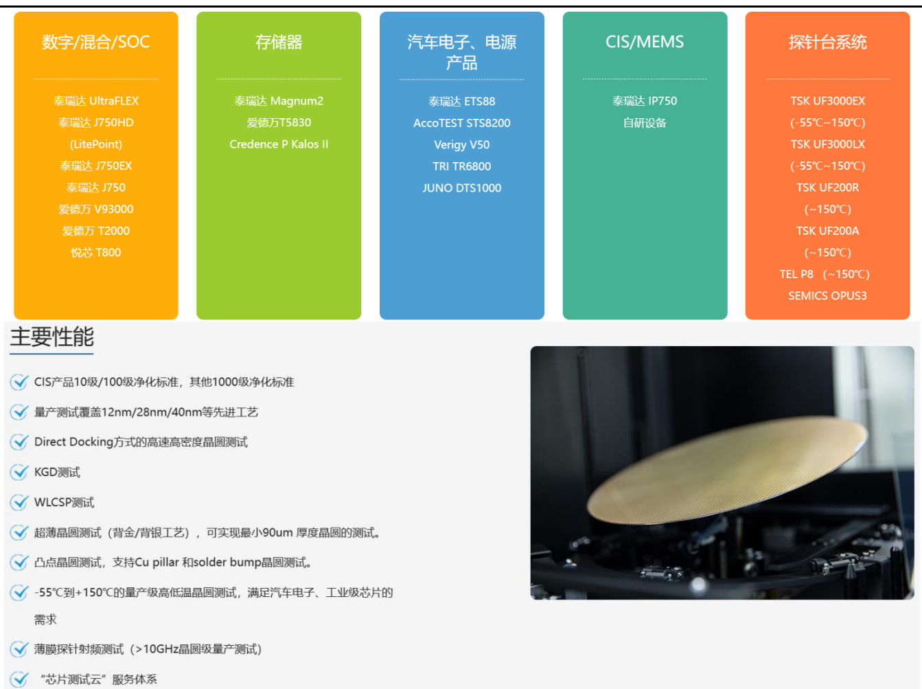
图14：公司晶圆测试平台及主要性能
