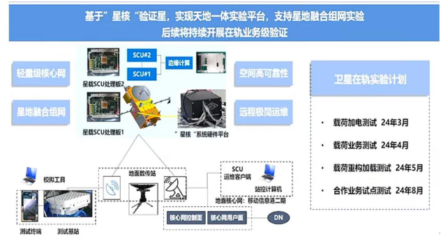
图 6：“星核”试验星在轨试验计划
