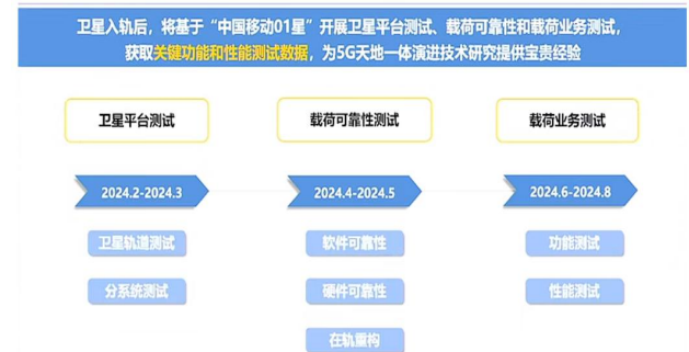
图 4：中国移动 01 星在轨测试计划
