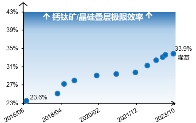
图表3：钙钛矿-晶硅双结电池效率七年提升 10pct+
