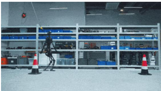
图表 53：傅利叶智能的 GR-1 具有敏捷避障能力
