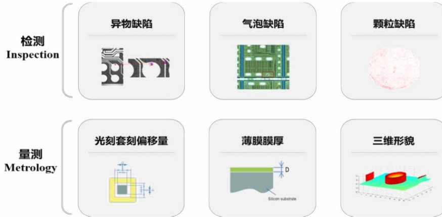
图 7：过程控制工艺可细分为检测和量测两大类
