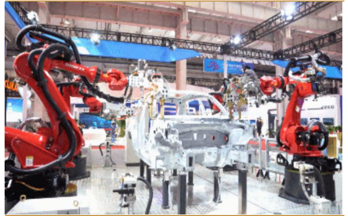
图 9：新松 SR210A-210/2.65 工业机器人实现了国产工业机器人在汽车点焊高端应用领域的里程碑式突破
