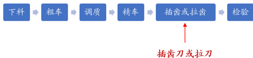
图32：减速器内齿圈加工需要用到插齿刀或拉刀
