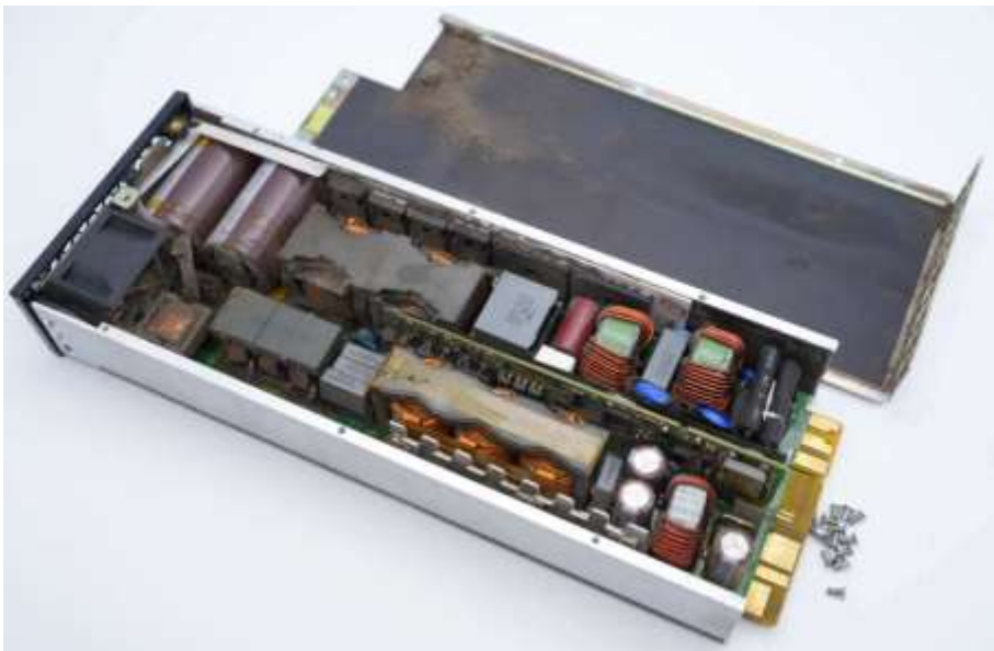
图表28：华为某型号服务器电源拆解
