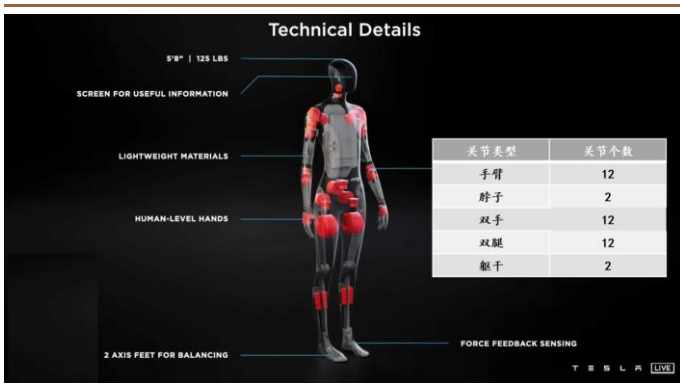
图 38: Optimus 全身共搭载 40 个旋转执行器
