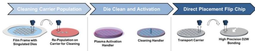
混合键合工艺流程
