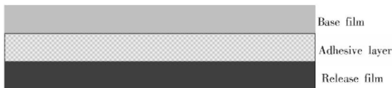
图24: 通用 UV 膜结构图
