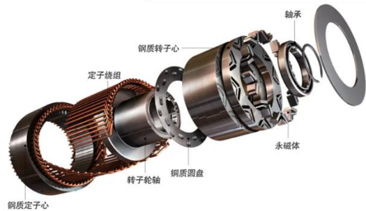
图 16：通用汽车永磁同步电动机构造图
