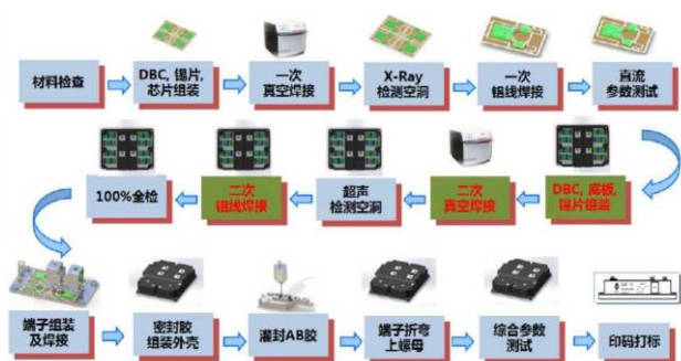
图表22：IGBT封装全过程
