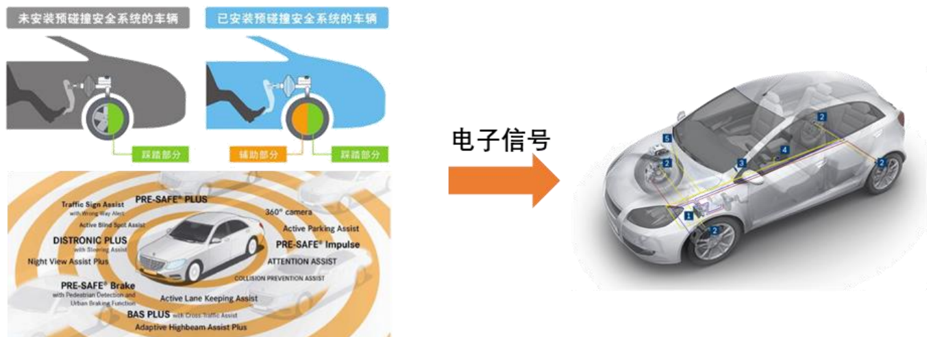
图表6：线控制动可以更好配合主/被动安全系统
