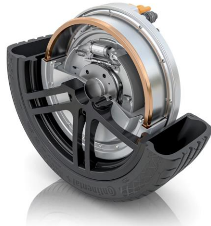
图表28：大陆集团集成制动器的轮毂驱动单元
