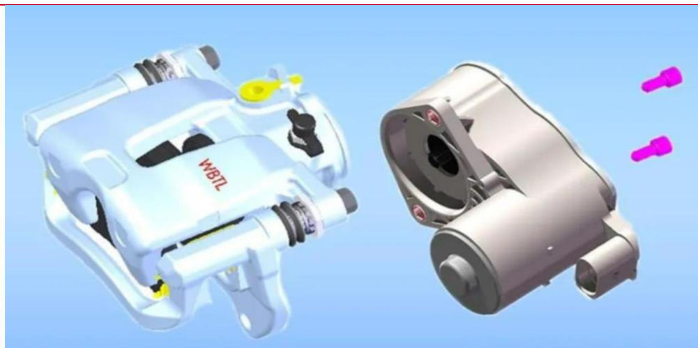
图表24：伯特利前湿后干(WCBS+EHC)制动系统技术方案
