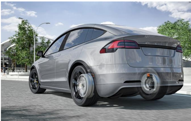
图表29：驱动制动集成模块可以直接安装在车轮
