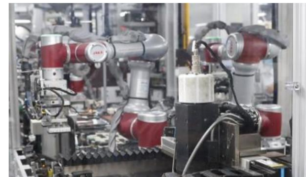
图4: 协作机器人-高精度工业场景（上下料及涂胶）
