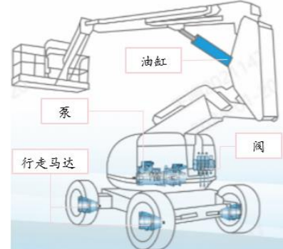
图表51：臂式高空作业平台核心液压系统示意图
