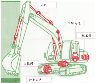
图表50：挖掘机核心液压系统示意图
