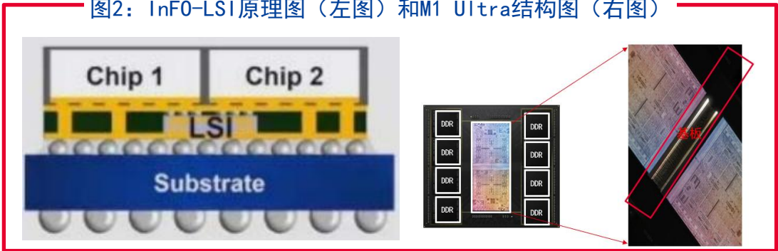
图2：InFO-LSI原理图（左图）和M1 Ultra结构图（右图）
