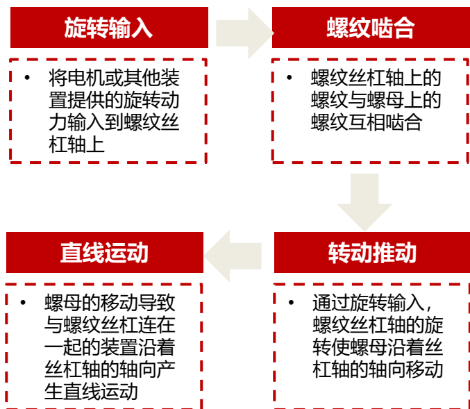
图：梯形丝杠工作原理
