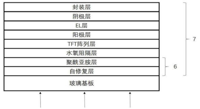
图56: 柔性显示基板中包含聚酰亚胺薄膜
