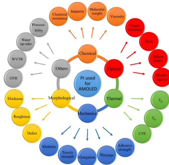
图69：用于 AMOLED 的 PI 参数要求更为严格
