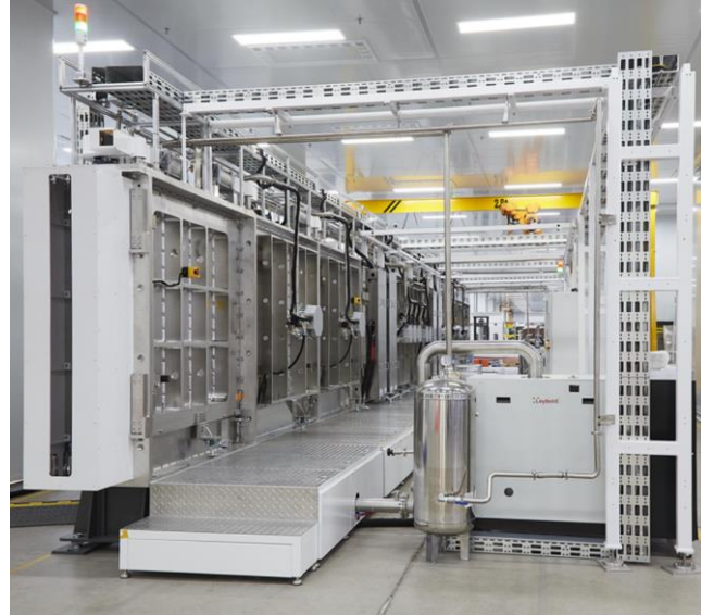
图36 捷佳伟创大面积钙钛矿薄膜立式量产设备
