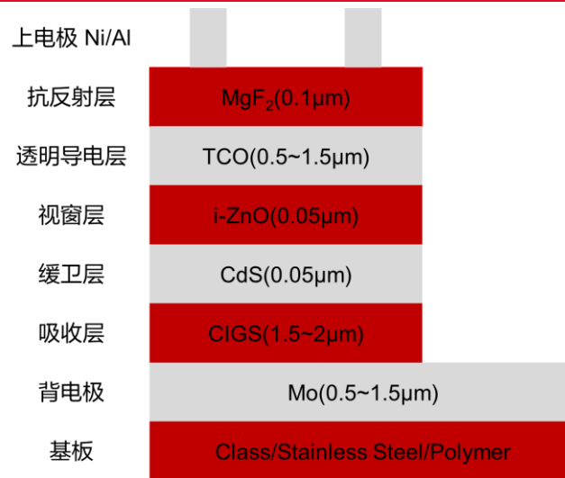
图2 CIGS 薄膜太阳能电池结构
