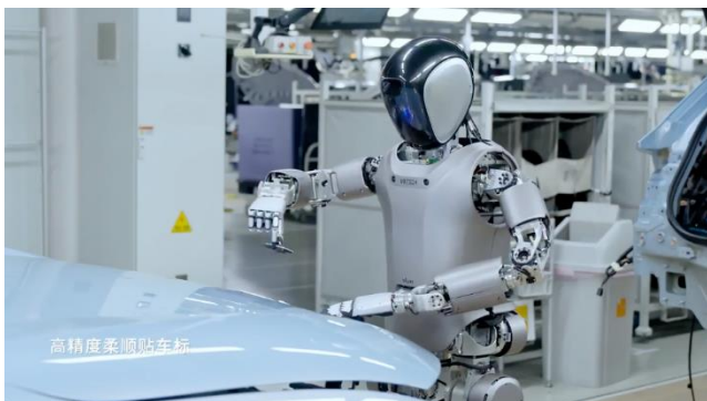
图3: 优必选 Walker S 在蔚来工厂完成贴车标工作
