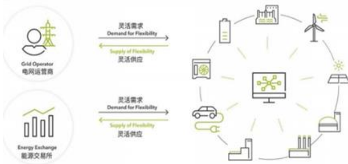
图 54：德国 NextKraftwerke 虚拟电厂系统架构图
