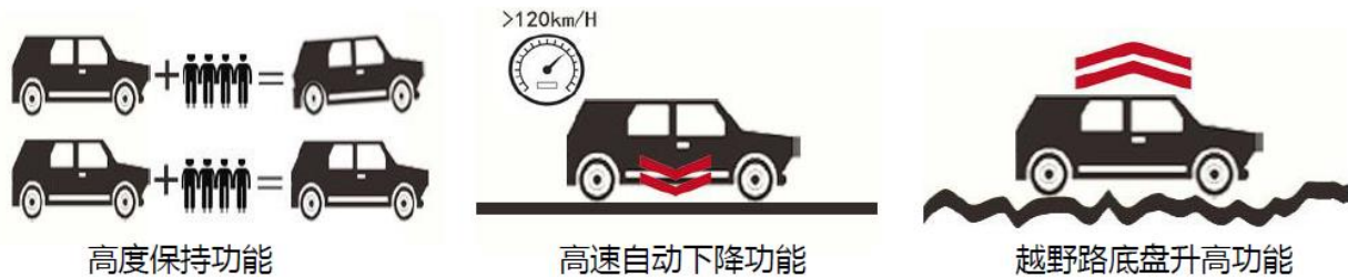
图表8 空气悬架使得车辆底盘可实现高低调节，提升通过性、降低风阻
