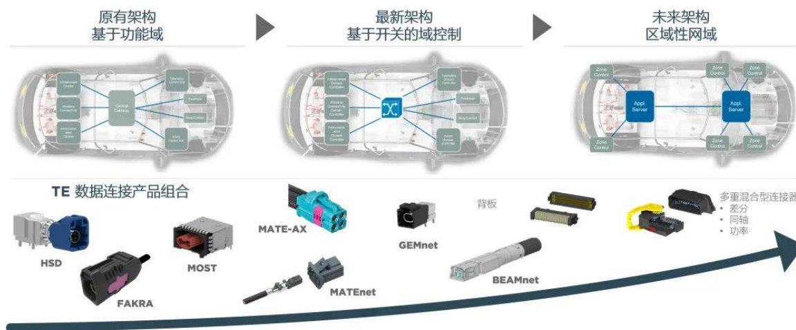
图29：汽车架构的演进及连接器的变化趋势
