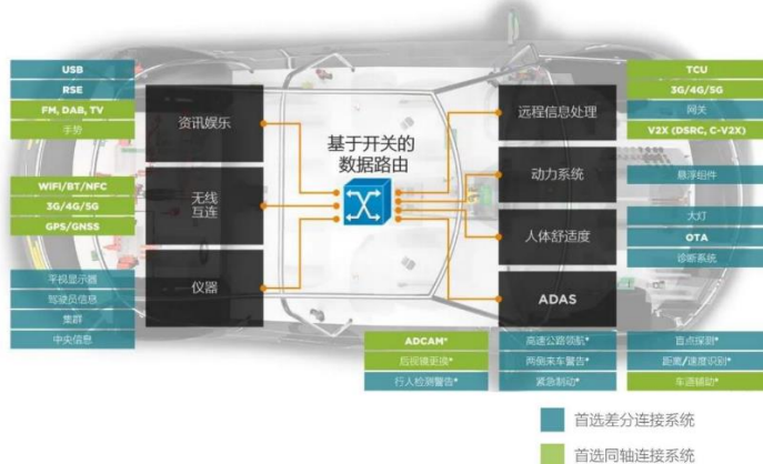
图22：汽车高速连接器不同场景适用产品类型
