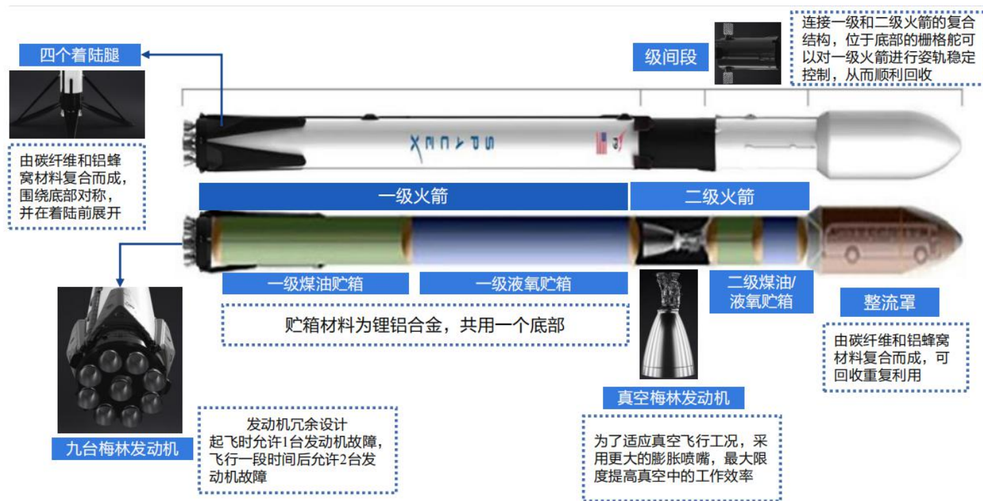
图表：猎鹰9号结构图
