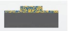
④第二片晶圆图案化（曝光显影），刻蚀等
