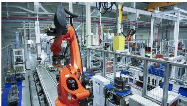
图 17: 公司螺杆压缩机自适应智能装配线
