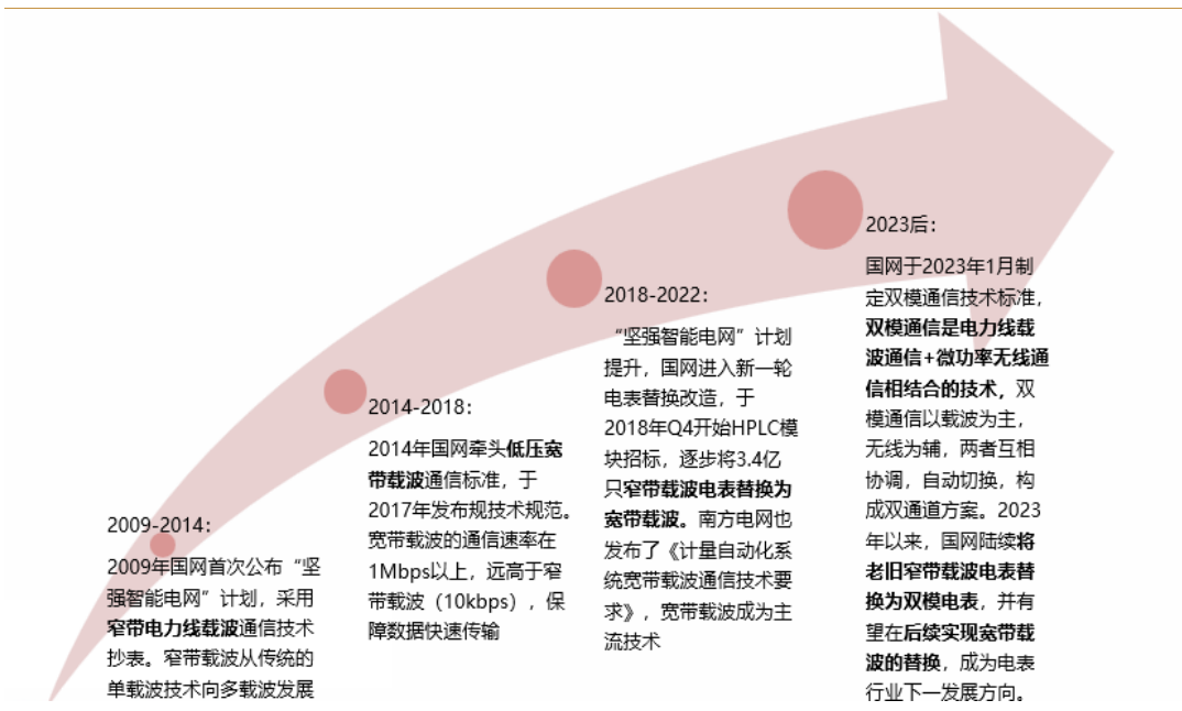
图 12：电表上游通信模块技术发展历程
