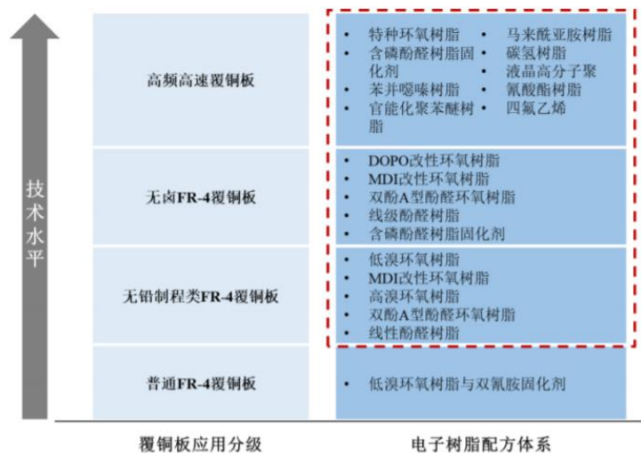
图7:覆铜板应用分级和电子树脂配方体系
