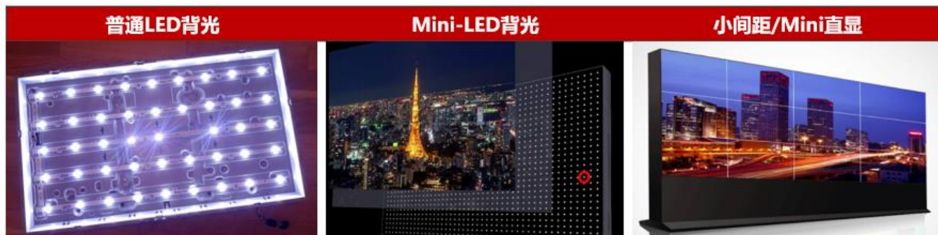
图1：普通 LED 背光、Mini LED 背光及小间距直显产品应用对比
