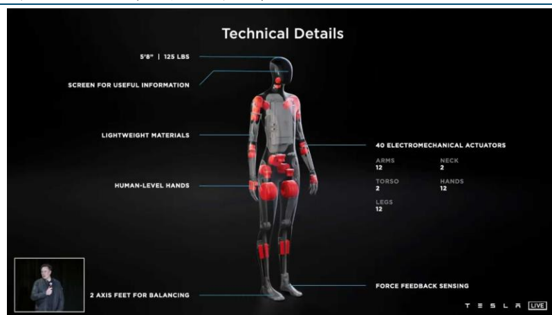
图表12：特斯拉机器人全身包含 40 个关节电机
