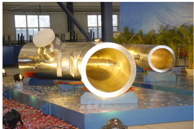
图 17：核电站主管道
