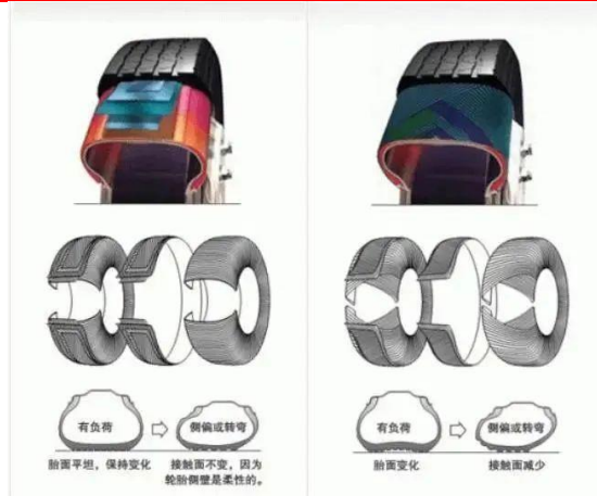
图 27：子午线轮胎（左）与斜交胎（右）结构差异
