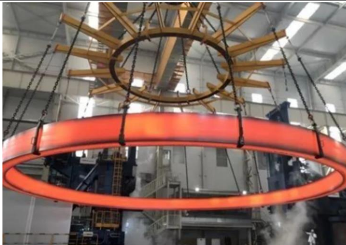
图6：15.6 米直径整锻式不锈钢环形件
