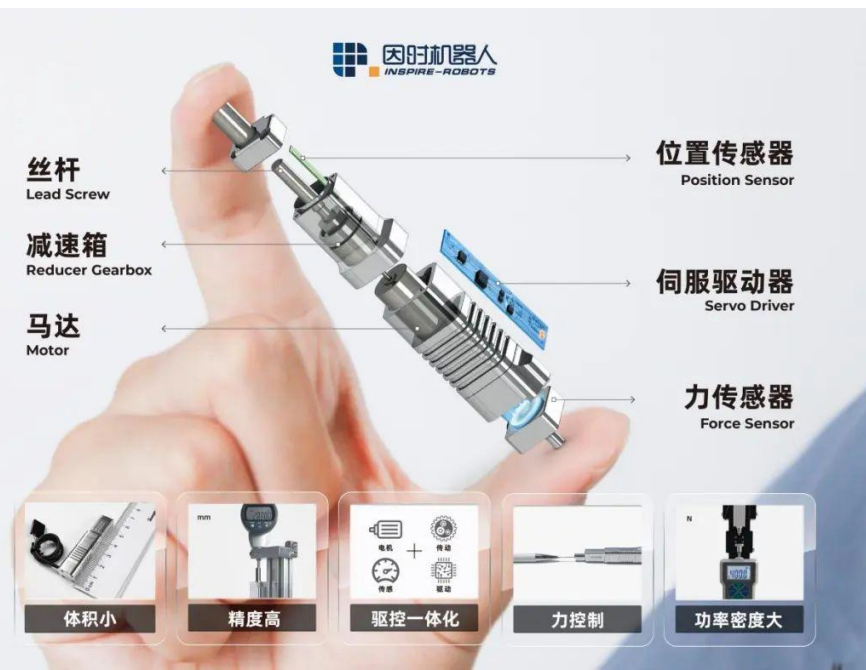
因时机器人微型伺服电缸构成
