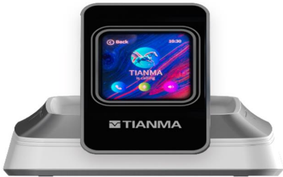
图 18：1.63 英寸超高 PPI 主动式 Micro-LED 显示屏
