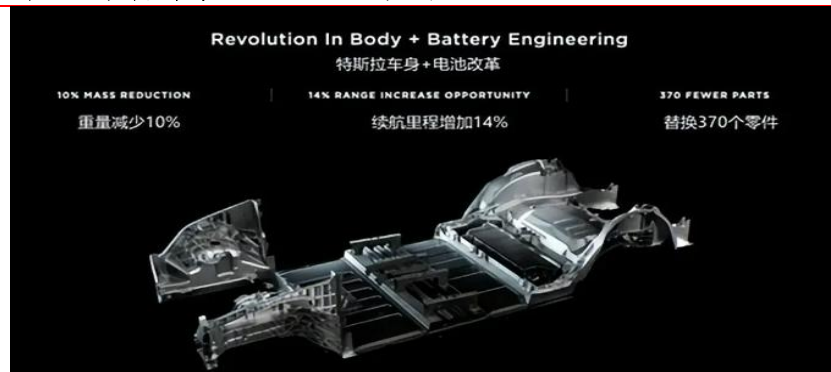
图 14：特斯拉车身+电池一体化压铸方案
