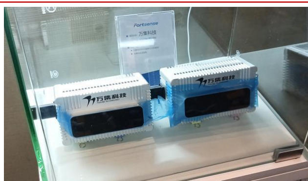
图 17：万集推出基于阜时科技 SPAD 芯片的 Flash 全固态激光雷达产品
