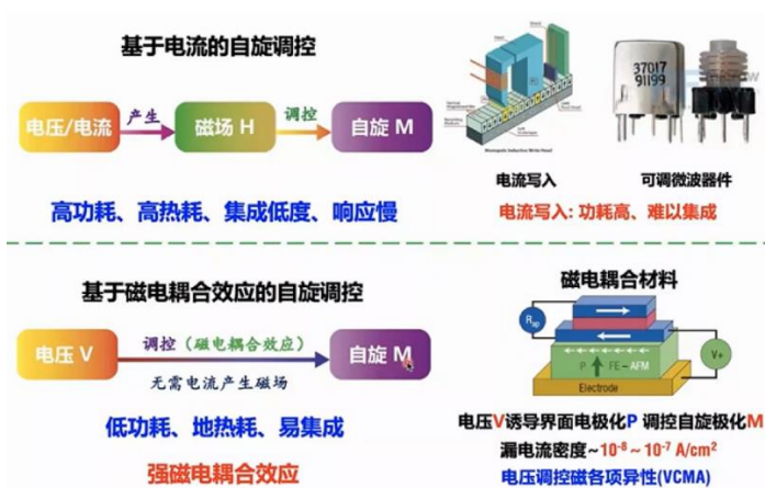
图3 基于电流和磁电耦合效应的自旋调控
