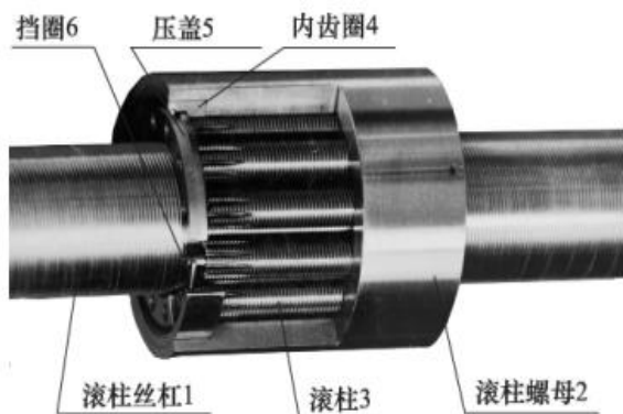
图 32：行星滚柱丝杠构成
