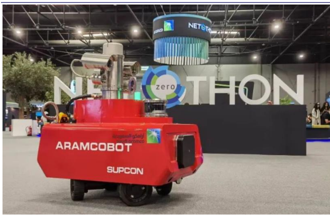
图表41：公司研发的智能巡检机器人
