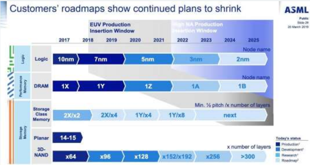
图24：存储芯片、逻辑芯片制程趋势图
