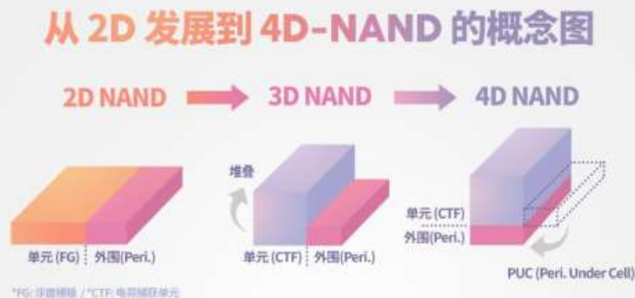
图67：2D NAND到4D NAND的概念图
