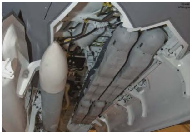
图表5：一个 F-35 内置弹舱可挂载 4 枚 SDB 2
