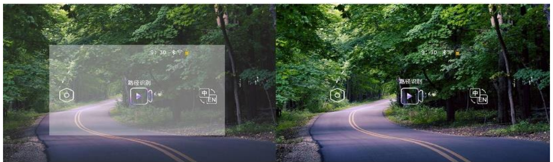
图表 44. 表面浮雕衍射光波导（左）与阵列光波导（右）的显示效果对比
