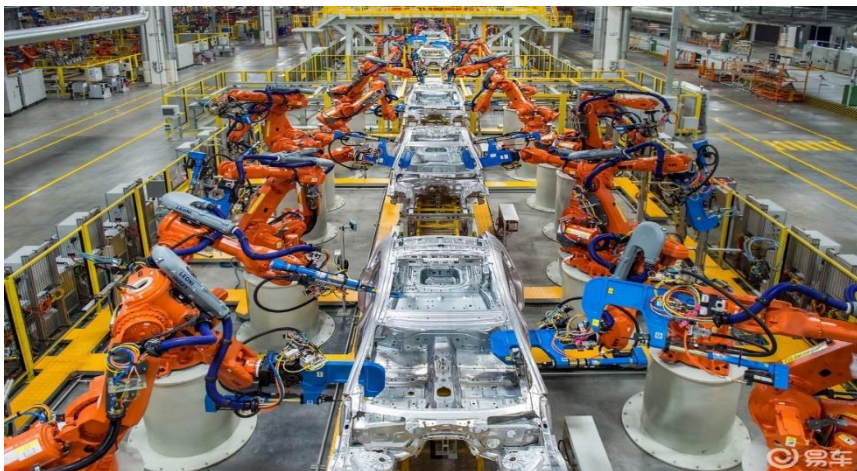
图：固定工位的汽车焊接机器人
