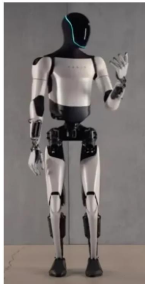
2023年 12月 Optimus Gen 2行走速度 提升30%，减重10kg，所 有手指都有触觉
