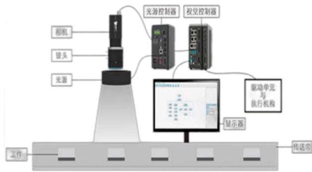
图 10：一个典型的机器视觉系统
